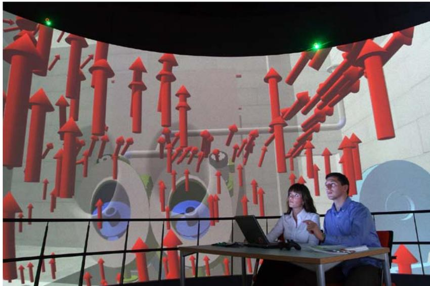
ViERforES: Simulation verfahrenstechnischer Anlagen. Durch eine Kombination von VR-Modell und Strömungssimulation können die Stoffströme in einer Anlage dargestellt und optimiert werden. Bild: Fraunhofer IFF
